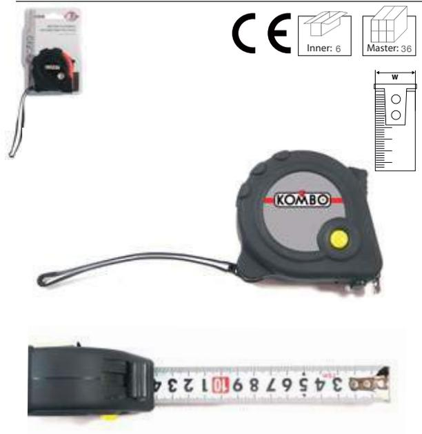
Metro flessibile autoretrattile con clip 7,5MT x 25mm. Bloccaggio a pulsante con ritorno, 2 pulsanti di bloccaggio supplementari (Laterale e Sotto). Cassa in Materiale Sintetico rivestita in Gomma, Rigidità del Nastro fino a 150 CM. CE, resiste a cadute da 4 Metri di altezza
