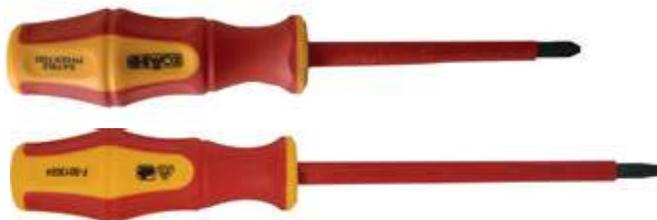
Punta con taglio phillips e spaccato magnetica, isolati 1000V. Punta in Cromo vanadium interamente brunita e rivestita. Marcatura GS a Norma VDE DIN EN 60900 (VDE0682-201); 2013-04 + EN 60900:2012. Manico ergonomico antiscivolo bicolore in ABS.
