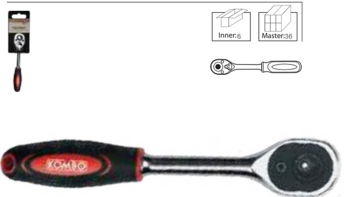
Crichetto reversibile a 72 denti in acciaio alta qualità, inversione a leva, sgancio rapido della bussola, manico in polipropilene + grip in TPR
